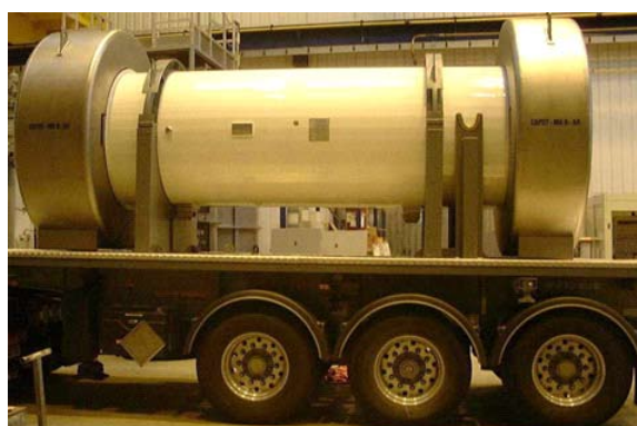
Figuur 4.2.2 Links: MX6 transportverpakking voor MOX (zonder security vehicle). Rechts: Transportverpakking met uraniumelementen op vrachtwagen.
