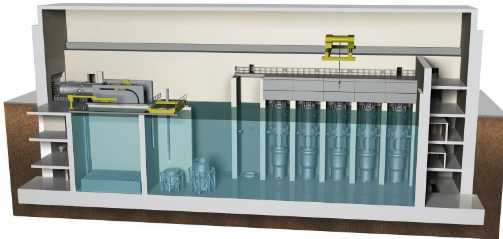
Figuur 3.1: Voorbeeld van een SMR ontwerp waarbij het aantal reactor-modules kan worden aangepast aan de energiebehoefte, bron: NuScale Power Reactor
