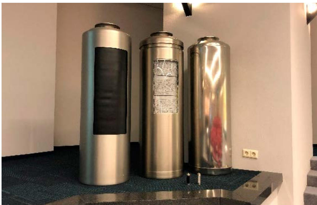
Figuur 2 Demonstratie canisters voor hoogradioactief afval, met links verglaasd afval en in het midden samengeperst metallisch afval
