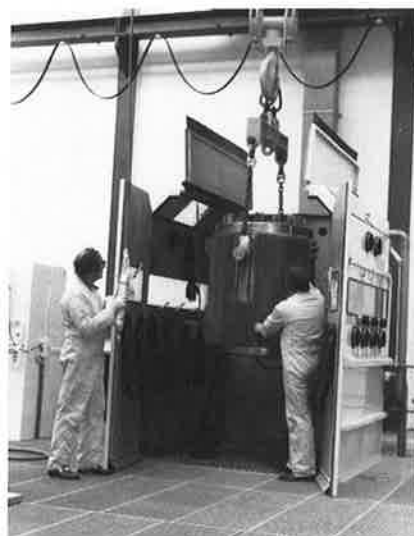
Glasstraler voor reiniging van grote voorwerpen.
