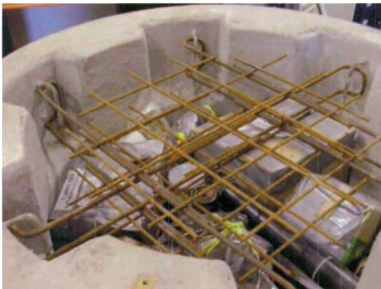
Figuur 6.11: Bronnen overgepakt in een 1000 l betoncontainer
