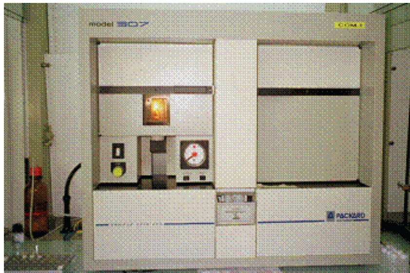
Figure 4.4 - Oxydiser et Schéma de principe de la mesure du tritium organiquement lié par Oxydiser.
