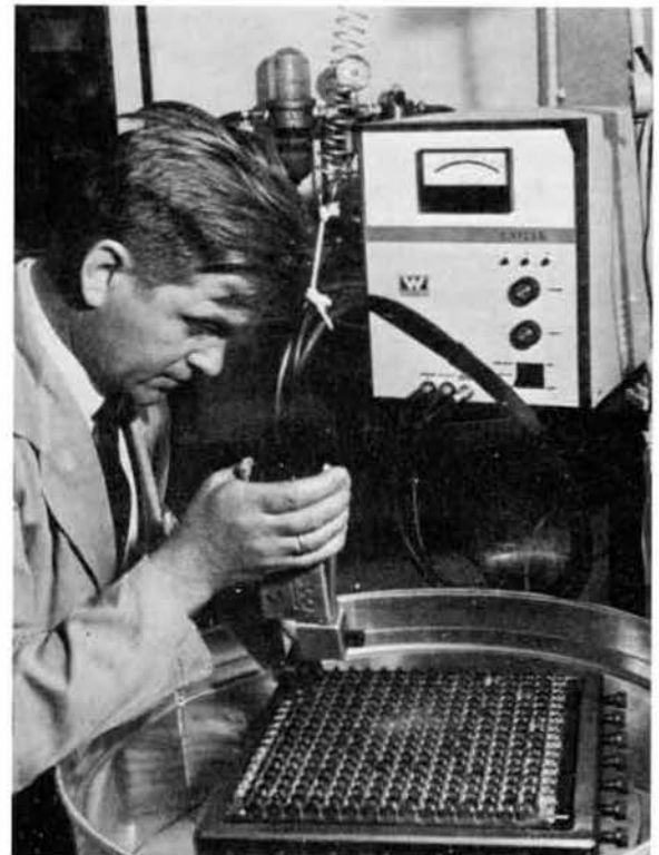
Figuur 2. Samenbouw van een tussenrooster voor 'Otto Hahn'-element.
