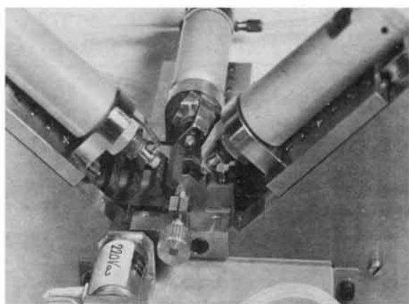
Figuur 6. Automatische dimensiemeting van bestraalde grafietmonsters voor het OECD DRAGON-project.
